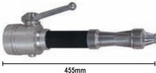
Lancia Antincendio a getto multiplo. Interamente costruita in lega di alluminio leggera con guarnizioni in gomma. Funziona mediante valvola a sfera e tramite un dispositivo produce un largo getto di acqua frazionata. La leva di comando permette il passaggio da chiuso a getto pieno o frazionato. In posizione di getto pieno è garantito un passaggio d'acqua omogeneo. Per usi frequenti.
