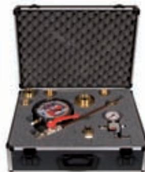
N.B. Per Ogni ugello verrà fornita, stampata sul manometro, una tabella riassuntiva con su specificata la Pressione dinamica e la Pressione residua (esprese in bar), riferita agli ugelli diam. 7-12-16 mm., Portata H<sub>2</sub>O erogata (lt./min.) e Coefficiente K, come previsto dalle norme UNI EN / 671-2:1996 Punto 10.3.
